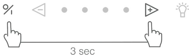
Zum Ausschalten der InTouch-Funktion die Taste ① und die ② Taste gleichzeitig 3 Sekunden lang gedrückt halten. Die zweite und dritte LED blinken zur Bestätigung dreimal. (Das Gerät muss ausgeschaltet sein).
