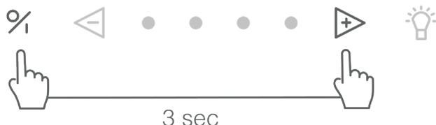
Om de InTouch functie uit te schakelen toets ❶ en toets ❷ tegelijk indrukken voor 3 seconden de 2e en 4e LED knipperen 3 keer ter bevestiging. (Het toestel moet uitgeschakeld zijn).
