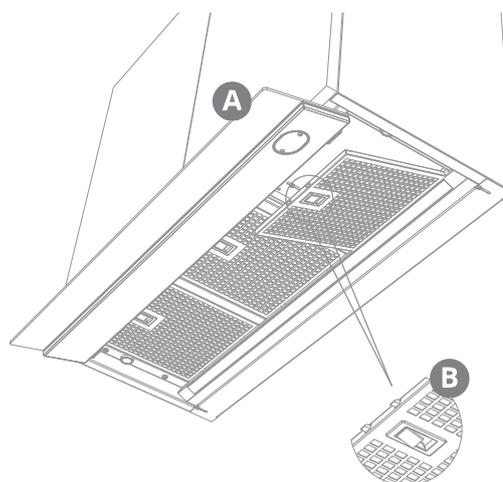
Ouvrez le carter pivotant A. Protégez votre plaque de cuisson. Vous pouvez extraire le filtre à graisse B de la hotte en retirant la poignée qui se trouve sur le filtre. Le filtre se dégage alors vers le bas.
