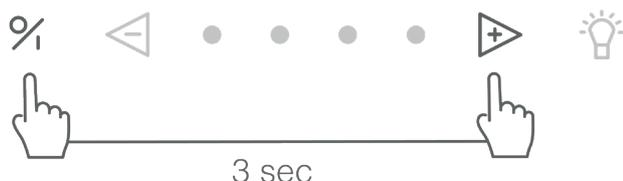
Pour désactiver la fonction InTouch, appuyer simultanément sur les touches ❶ et ❷ pendant 3 secondes. Les 2ème et 4ème LEDs clignotent 3 fois pour confirmer. (L'appareil doit être éteint).
