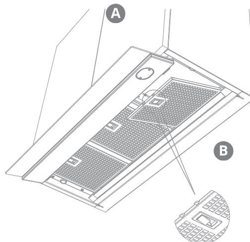
Schützen Sie das Kochfeld. Öffnen Sie den Schirm / die Unterplatte A. Den Fettfilter B können Sie aus der Dunstabzugshaube nehmen, indem Sie am Griff ziehen, der sich am Filter befindet. Der Filter bewegt sich dann nach unten.
