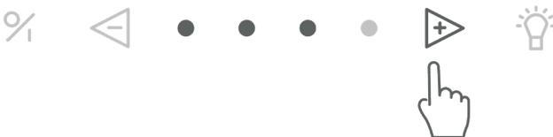
Drücken Sie auf die Taste ② um den Motor auf höhere Stufen zu verstellen.
